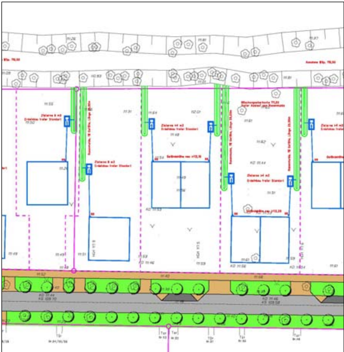
Abb. 10: möglicher Standort der Zisternen und Lage der offenen Mulden zur Ableitung des Niederschlagswassers
