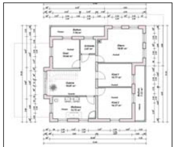
Abb. 7: Grundriss Dachgeschoss eines geplanten Einfamilienhauses
